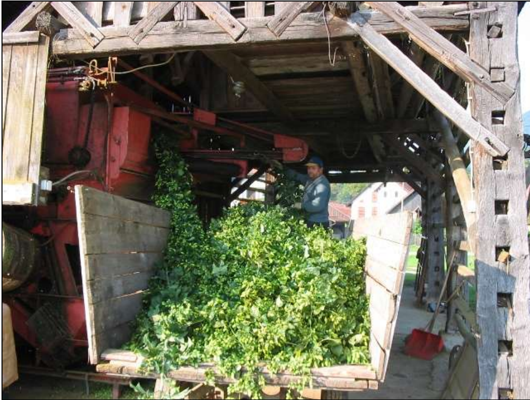
Slika 46. Še ne obrane panoge hmelja so vzporedno položene na voz in delavec jih eno za drugim zatika na tekoči trak obiralnega stroja (foto: V. Hazler, 24. 8. 2006).
