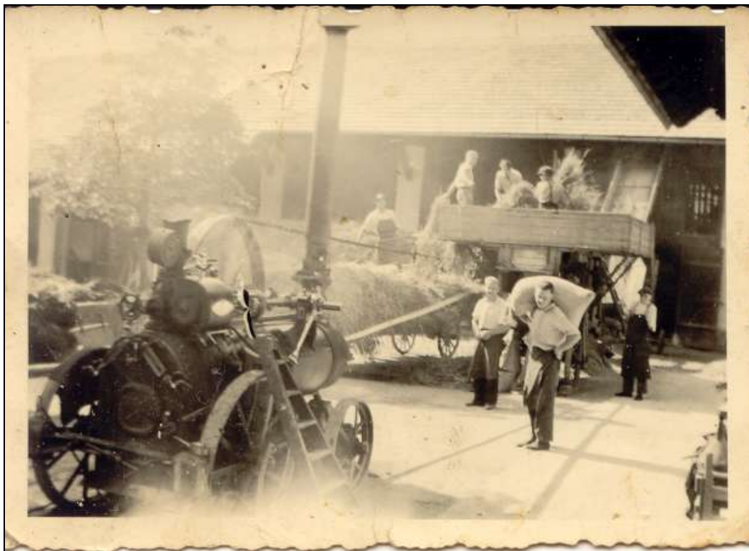
Slika 34: Lokomobila poganja mlatilnico na Rančigajevi kmetiji okrog leta 1935 (vir: fotoarhiv OEIKA FF UL).
