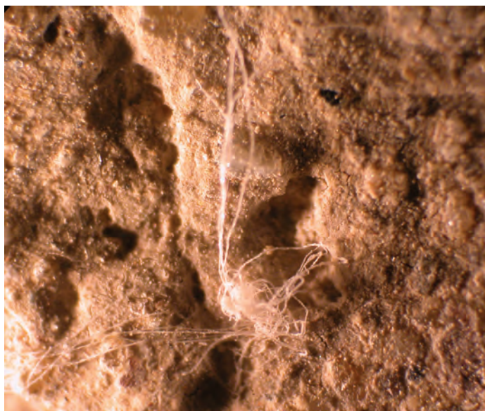
50. TURNIŠČE – vlakno slamice v ometu, fotogra- fija narejena s pomočjo optičnega mikroskopa
