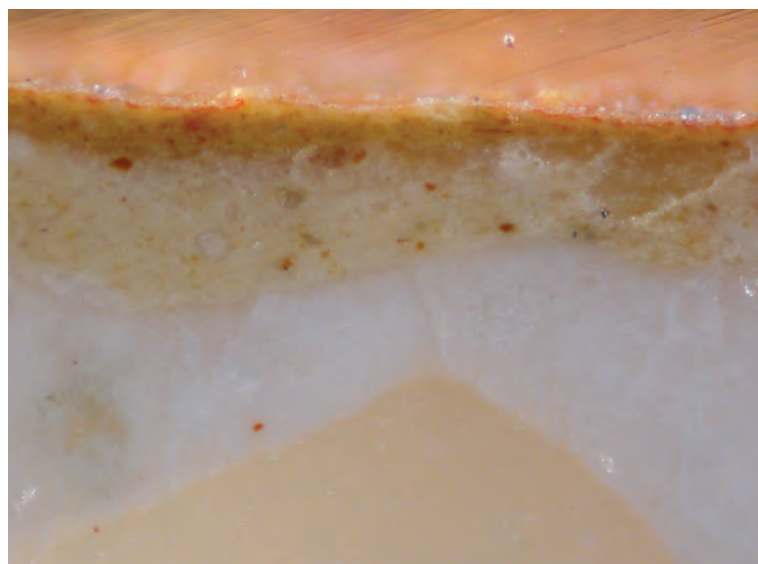
42. SV. JANEZ OB BOHINJSKEM JE- ZERU (BOH 6) – PREČNI PREREZ VZORCA DRAPERIJE SVETNICE: OMET, DEBELA OSNOVNA BARVNA PLAST, TANJŠA RDEČERUMENA IN TANKA RDEČA PLAST (x100)
