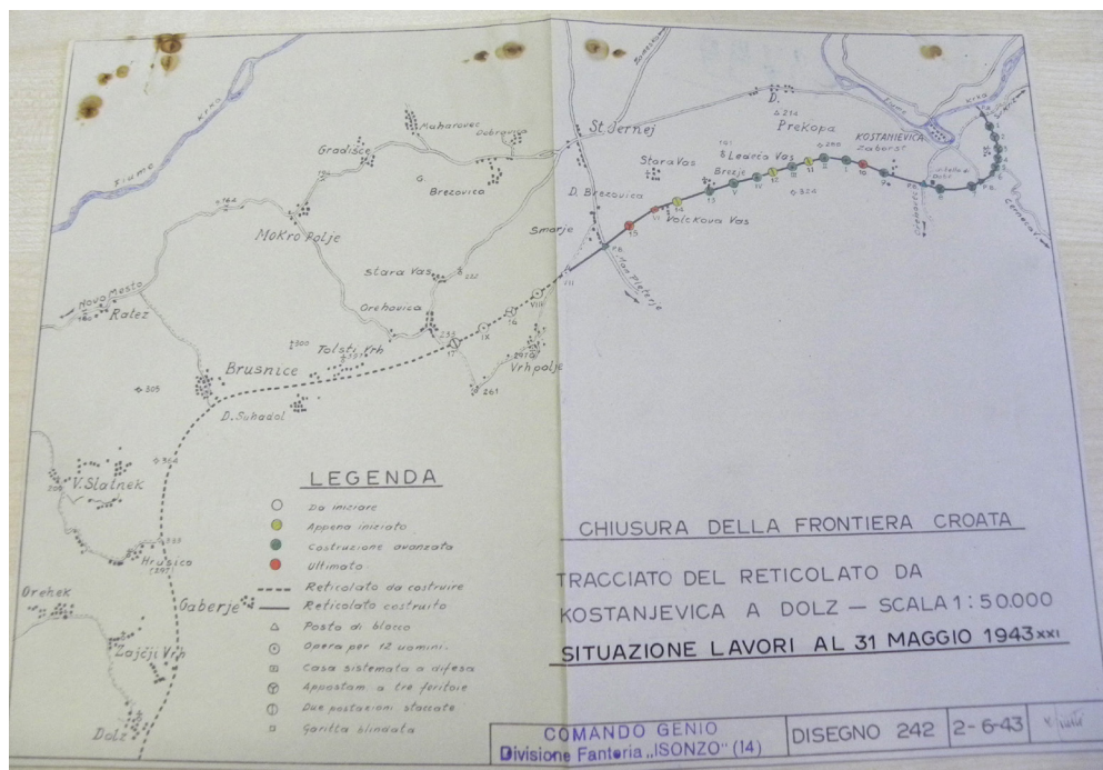
Slika 9: Zemljevid zapore meje z NDH pod Gorjanci, ki ga je pripravila inženirija divizije Isonzo. Prikazuje stanje dela postavitve bodoče žice in bunkerjev do 25. maja 1943. Bunkerji so označeni s krogi in povezuje jih bodoča žica. Rdeči krogi so dokončani bunkerji, rumeni in zeleni krogi so bunkerji v gradnji, krogi brez barve pa so predvideni bunkerji. Zelene črtice predstavljajo sekanje gozda.
