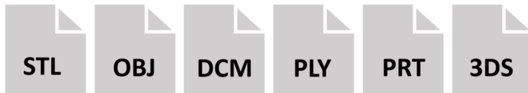
Slika 26: Različne vrste datotek za prikaz 3D-objekta (lastni vir).
