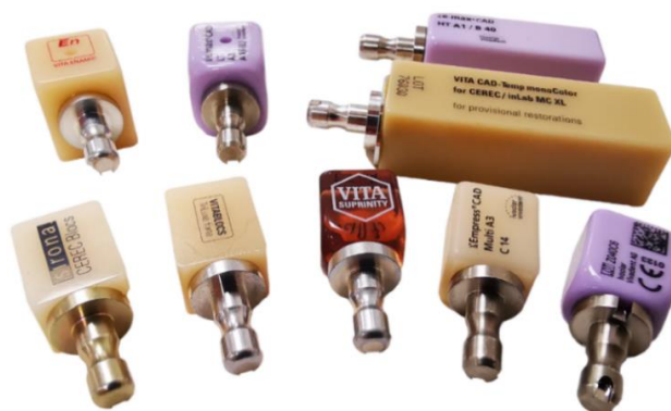
Slika 6: Raznovrstni bloki različnih keramičnih materialov (lastni vir).
