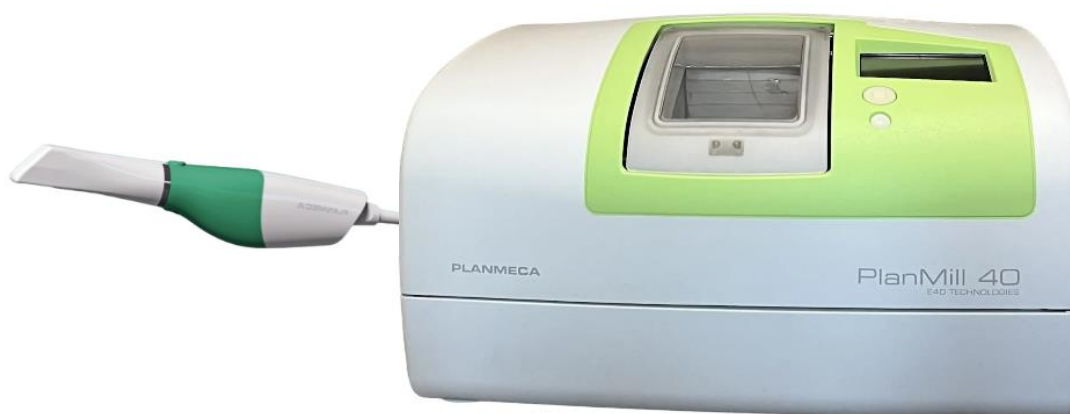
Slika 7: Rezkalna enota PlanMill® 40 in IOS (Planmeca) (lastni vir).
