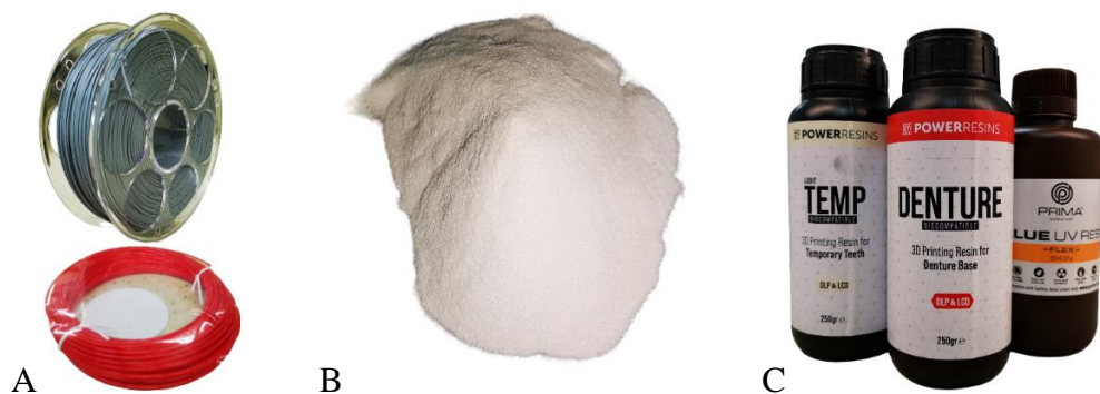
Slika 84: A – filament, B – praškasti in C – tekoči material za izdelavo z dodajalno tehnologijo (lastni vir).
