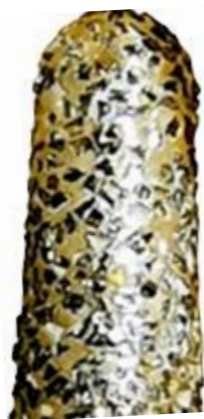
Slika 53: Diamantni brus z diamantnimi zrnji, vdelanimi v matrico (lastni vir).
