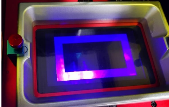
Slika 69: UV-osvetlitev čez zaslon LCD pod kadjo za fotopolimer (lastni vir).
