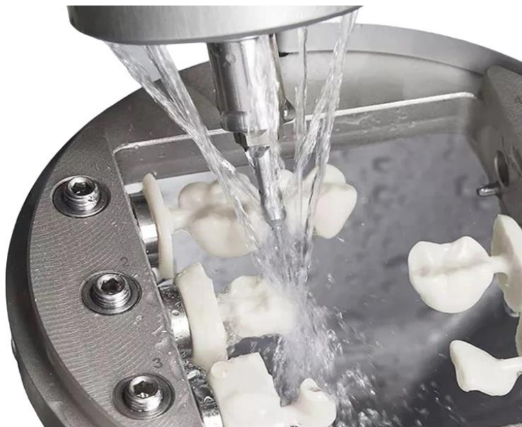
Slika 60: Mokra obdelava litijevega disilikata (lastni vir).
