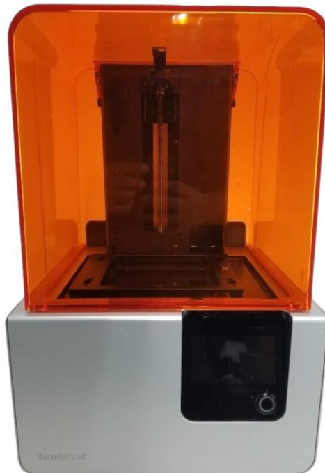
Slika 67: Tiskalnik SL Form 2 podjetja Formlabs (lastni vir).
