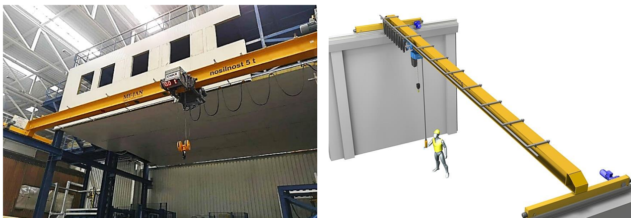
Slika 34: Primera mostnega dvigala
