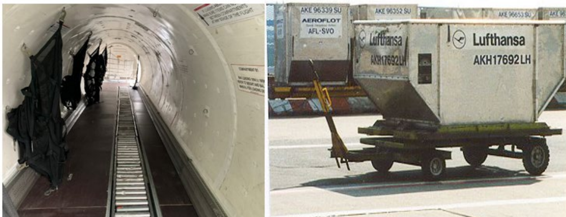
Slika 4.19 Primer notranjosti tovornega letala (SAAB340) in ULD
