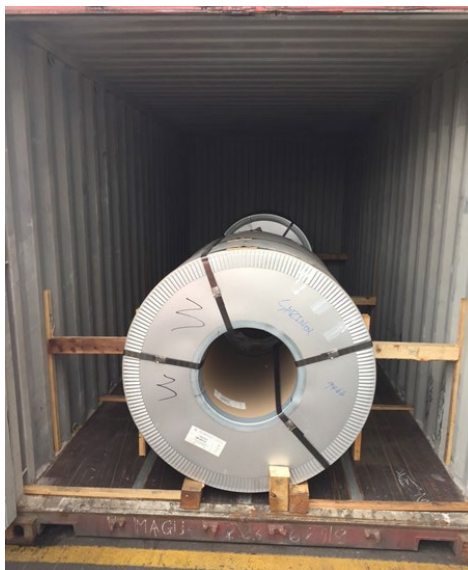
Slika 7.17 Zavarovanje zvitkov pločevine pri prevozu v kontejnerju
