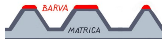
Slika 1: shematski prikaz preseka matrice visokega tiska (Dare Birsa, 2018)
