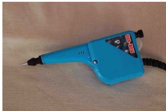
Slika 15: Električno orodje za punktiranje (wikipedia)
