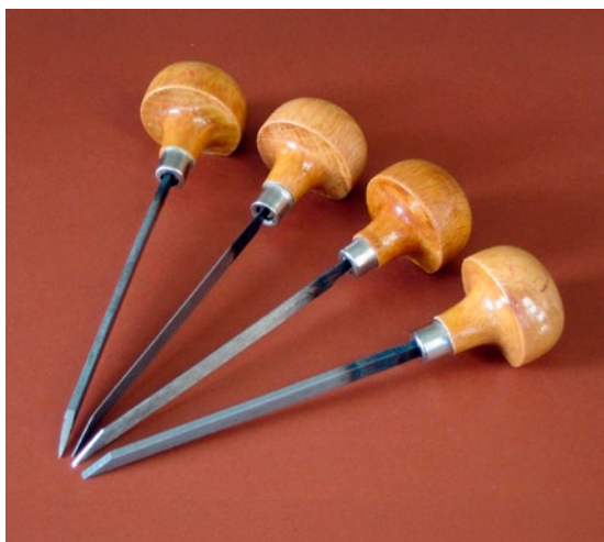
Slika 2: Dleta za lesorez (Alatke za izradu drvoreza, noževi i dleta raznih veličina i širina U i V preseka, wikipedia, 2024)
