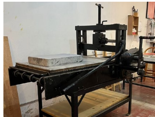
Slika 54: Erasmus Sutter, 1839, litografski tiskarski stroj s kolenskim vzvodom
