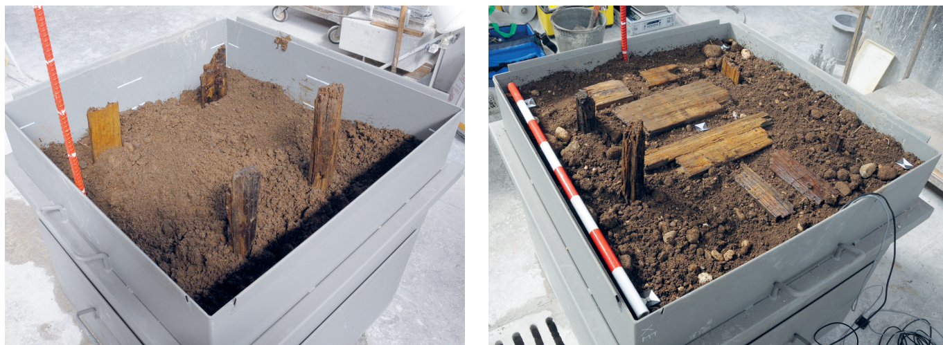
Slika 5.20: Namestitev lesenih preizkušancev v melj.
