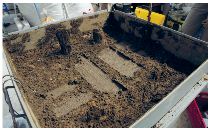
Slika 5.26: Odtisi že odstranjenih vodoravno nameščenih lesenih preizkušancev.
