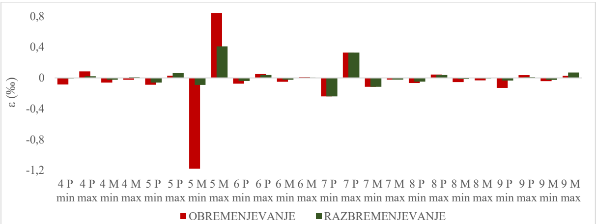
Slika 6.36: Največje minimalne (min) in maksimalne (max) deformacije ( \epsilon ) lopatic v produ (P) in melju (M) preizkusov 4–9 med obremenjevanjem (rdeča) in razbremenjevanjem (zeleni).
