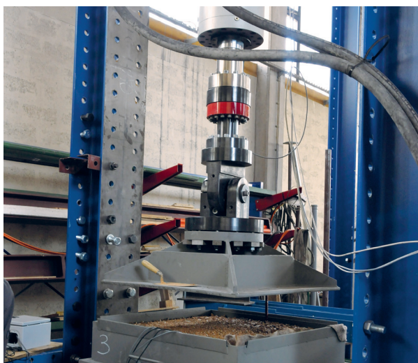
Slika 5.1: Obremenilna kvadratna plošča, prilagojena za namestitev na servohidravlični bat.
