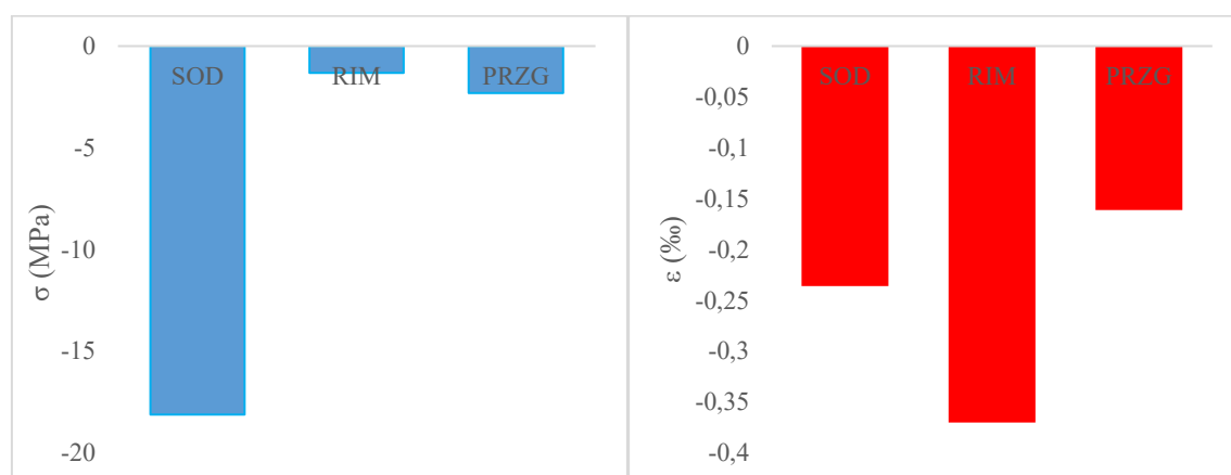
Slika 7.1: Napetosti (modra) in deformacije (rdeča) sodobnega (SOD), rimskega (RIM) in prazgodovinskega (PRZG) keramičnega preizkušanca ob nastanku prvih razpok v preizkusu 10.
