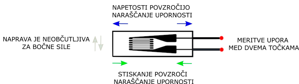
Slika 4.4: Shematski prikaz enojnega uporovnega merilnega lističa.
