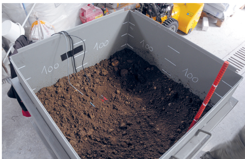
Slika 5.22: Namestitev merilcev vlažnosti in temperature v melj.
