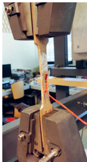
Slika 5.31: Izvedba nateznega preizkusa bronastega preizkušanca.
