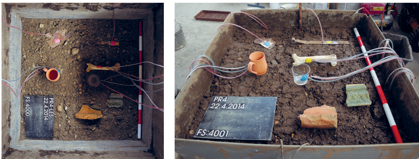
Slika 5.21: Namestitev preizkušancev v prod (levo) in melj (desno).
