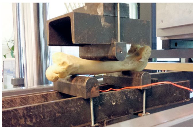
Slika 5.35: Izvedba tritočkovnega upogibnega preizkusa na koščenem preizkušancu (stegenici).
