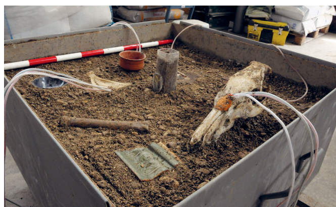
Slika 5.28: Izkopavanje preizkušancev v produ.
