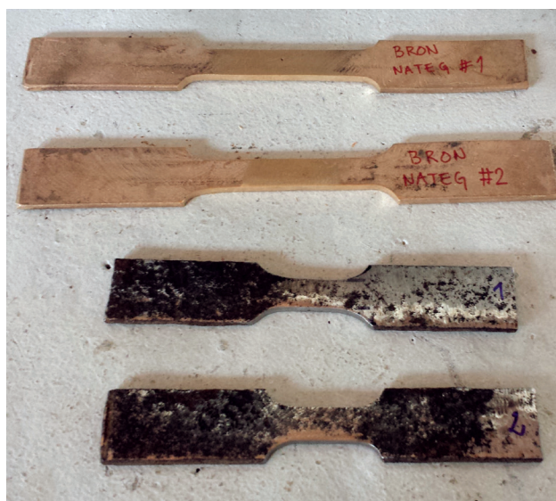
Slika 5.30: Bronasti (zgoraj) in železni (spodaj) preizkušanci za spremljajoče porušne preiskave.
