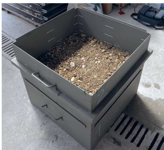
Slika 5.2: Celica, zapolnjena s prodom (levo) ter prodom in meljem (desno).
