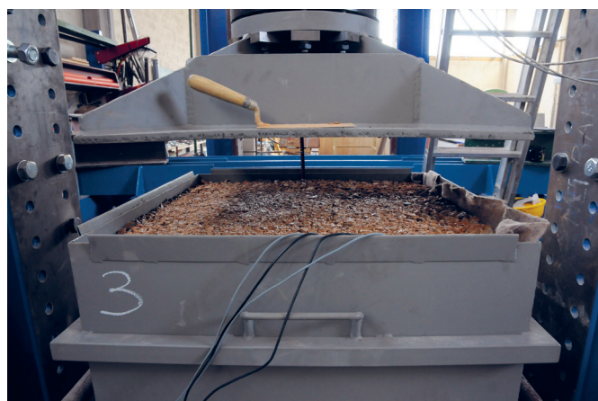
Slika 5.4: Namestitev zaščitnega sloja iz geotekstila in drobljenega kamenja.
