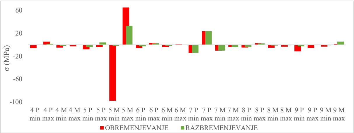
Slika 6.35: Največje minimalne (min) in maksimalne (max) napetosti ( \sigma ) keramike v produ (P) in melju (M) preizkusov 4–9 med obremenjevanjem (rdeča) in razbremenjevanjem (zeleni).
