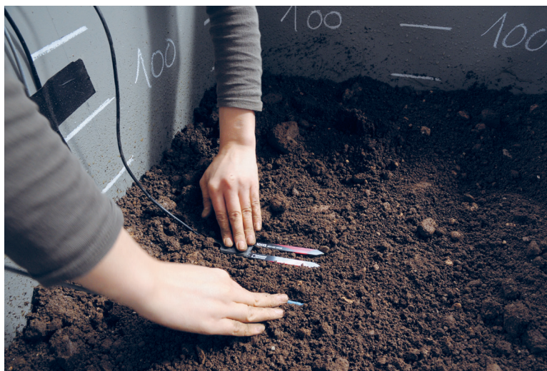
Slika 5.3: Nameščanje merilcev v plast melja.
