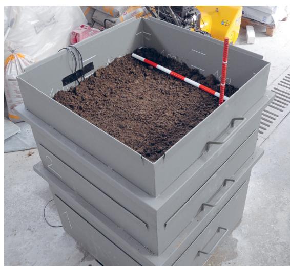
Slika 5.2: Celica, zapolnjena s prodom (levo) ter prodom in meljem (desno).
