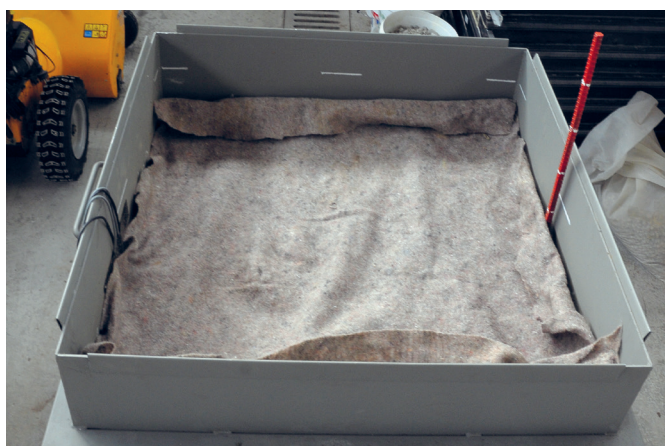
Slika 5.4: Namestitev zaščitnega sloja iz geotekstila in drobljenega kamenja.
