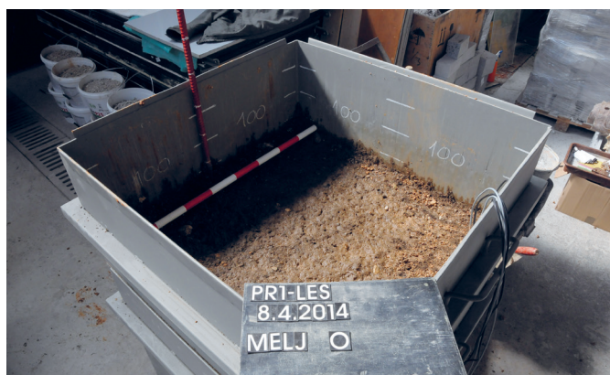
Slika 5.25: Vrhnja plast melja po obremenjevanju, zaščitni sloj in geotekstil sta že odstranjena.
