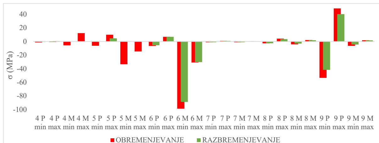
Slika 6.42: Največje minimalne (min) in maksimalne (max) napetosti ( \sigma ) stekla v produ (P) in melju (M) preizkusov 4–9 med obremenjevanjem (rdeča) in razbremenjevanjem (zelena).
