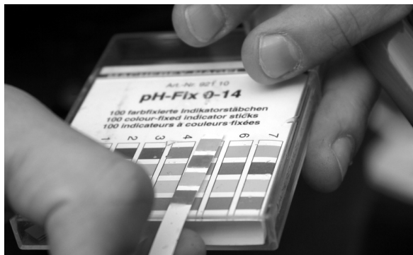
Slika 6: Meritev pH vode Avtor: Kardum Šibila, 2014.
