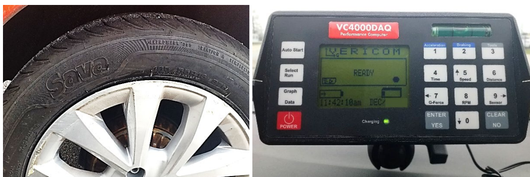
Slika 2. Pnevmatike, uporabljene za preskušanje zavorne učinkovitosti, in merilna naprava Vericom VC4000.
