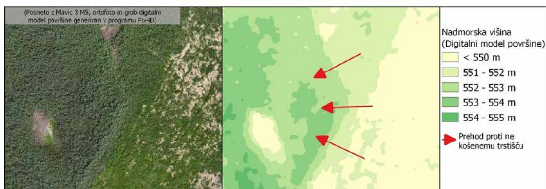
Slika 4: Ortofoto (levo) in digitalni model površine (desno), ki prikazuje razliko v višini košenega in nekošenega trstišča.
