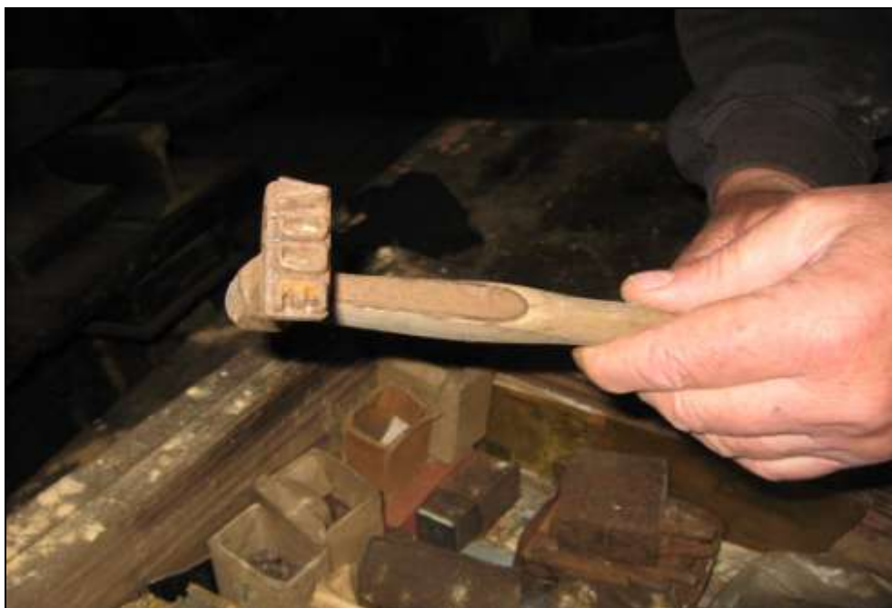
Slika 38: Pečatno kladivce z imenom lesnega trgovca, kakršne so v ključavničarski delavnici izdelovali Kersničevi. Kladivce je del zbirke orodja, nametnega v vitrino novega poslovnega pulta v »razvojno prenovljeni« delavnici (foto: V. Hazler, 6. 9. 2007).
